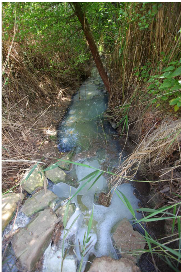
Obr. 25: Odtok z horizontálne pretekaného filtra je väčšinou priehľadný. Rozpustený amoniak nie je viditeľný ľudským okom. Niekoľko metrov od výpuste sa však vyčistená odpadová voda sfarbí do biela a jej zápach pripomína pokazené vajíčka. Tento zápach je dôkazom prítomnosti sírovodíka, ktorý je aj predpokladom vysokej koncentrácie amoniakálneho dusíka.
