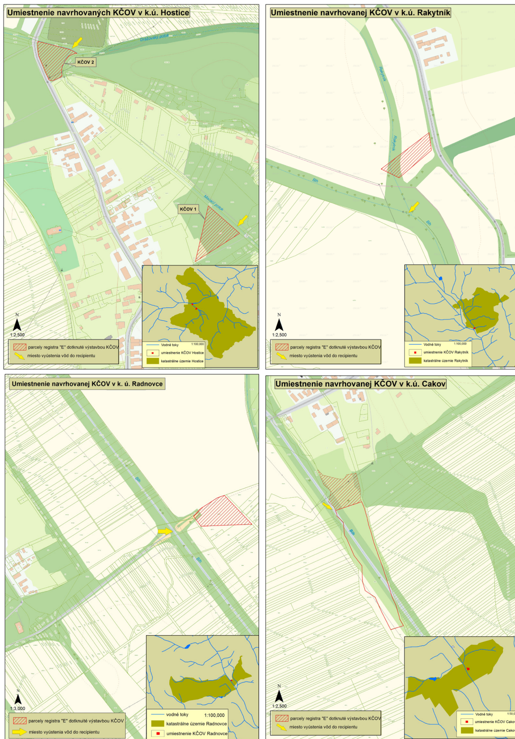
Obr. 46: Vhodné pozemky pre lokalizáciu koreňovej ČOV
